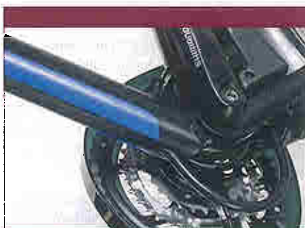
Nut- und Feder-Prinzip: Giant versteckt dicke Kabel in geschlitzten Rahmenrohren. Gummileisten verschließen (die Öffnungen).
