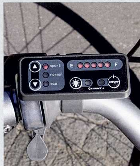
Nad středem najdete centrální mozek pohonu s indikátorem stavu baterie a módem přepínání intenzity práce motoru
